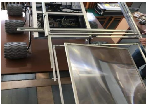
OBR. 58: MONTÁŽ MECHANIZMU ŠOŠOVKY
