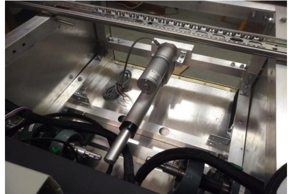
OBR. 20: ULOŽENIE AKTUÁTORA V SKRINI VOZIDLA
