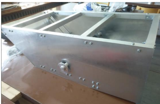
OBR. 49: MONTÁŽ PLECHOV NA RÁM SKRINE
