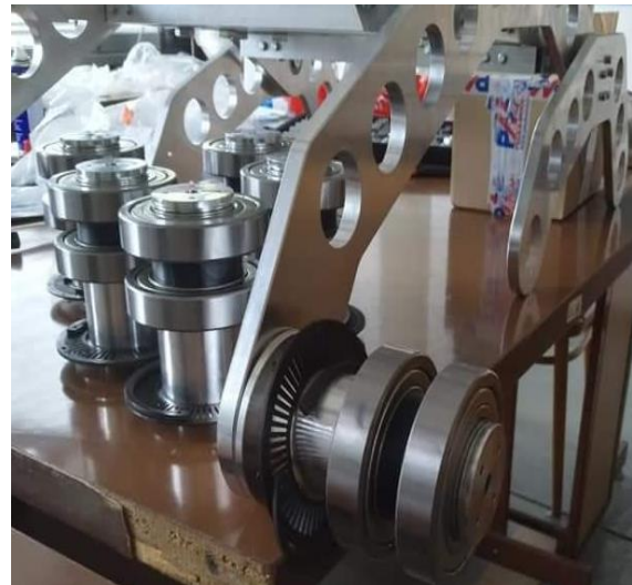
OBR. 37: MONTÁŽ ULOŽENIA KOLIES
