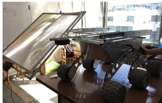
OBR. 59: MONTÁŽ MECHANIZMU ŠOŠOVKY
