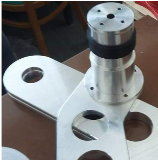
OBR. 36: MONTÁŽ ULOŽENIA KOLIES
