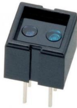
OBR. 31: OPTICKÝ ENKÓDER CNY70
